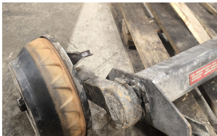
Износ и повреждение рычага
